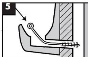
Cepille el contenedor del cartucho, y hacia dentro del tubo escape o evecuacion con un cepillo de 1.5 pulgadas de diámetro con cerdas de nylon.
