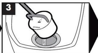
Levanta e inclinar el cartucho para drenar líquidos, después aplique la espuma limpiadora Falcon dentro del contenedor del cartucho.
